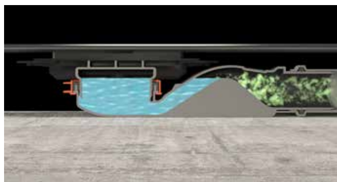
Siphon anti-odeur permanent grâce à la forme courbée
